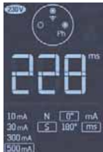
Ejemplo de medida del tiempo de disparo de un DDR 500 mA conforme.
